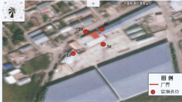
图1无组织废气检测点位示意图
