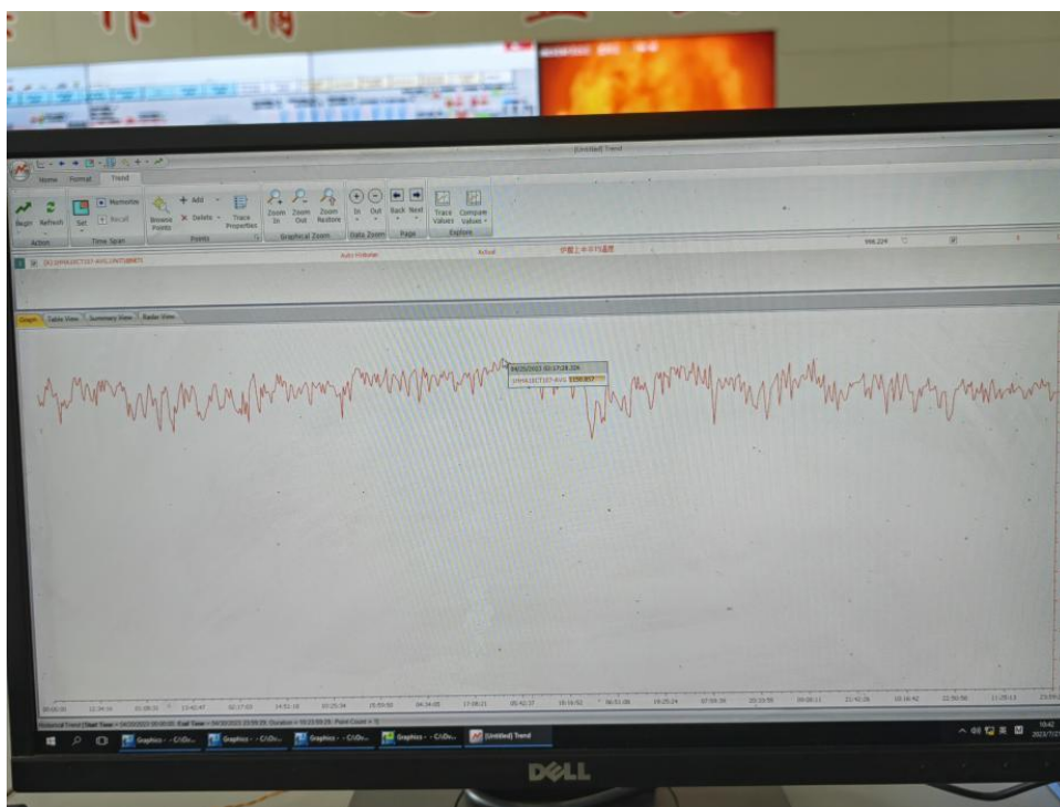
图 3.3-9 炉膛内燃烧温度曲线图（最高温）
